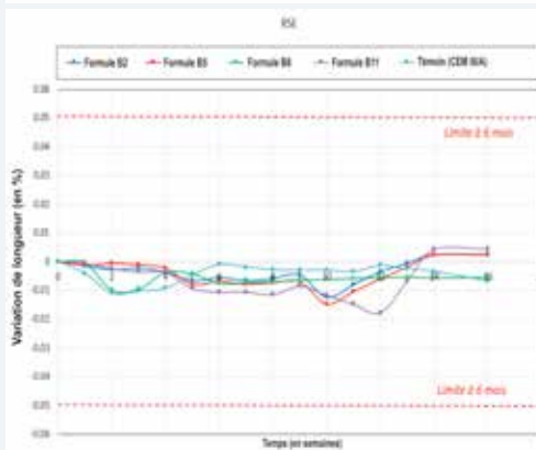
Graphique H - Variation dimensionnelle des bétons soumis à l'attaque sulfatique externe.
