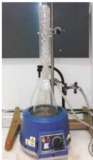
Dispositif expérimental de suivi de la consommation de chaux par test Chapelle.
